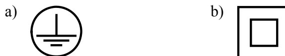
Rys. 5. Międzynarodowe oznaczenia urządzeń: a) klasy ochronności I; b) klasy ochronności II w wykonaniu fabrycznym
